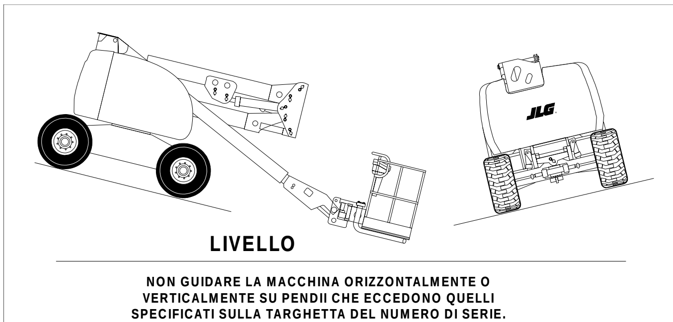
Figura 4-1. Avanzamento orizzontale e verticale su un pendio
