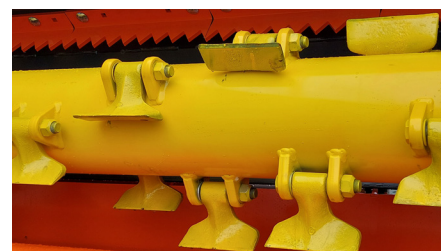
Rotor double spirale à marteaux et 2 contre-couteaux intérieurs
