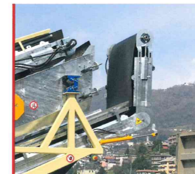
Nastro trasportatore principale ripiegabile idraulicamente per facilitare il trasporto.
