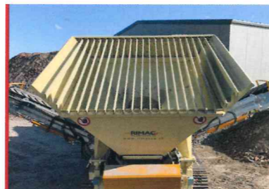
Tramoggia di carico con griglia vibrante.
