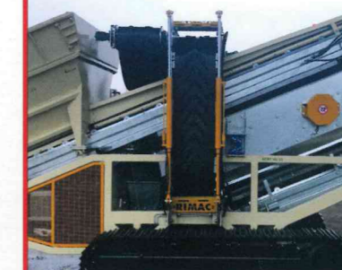
Nastri trasportatori laterali con sistema di apertura/chiusura idraulica.
