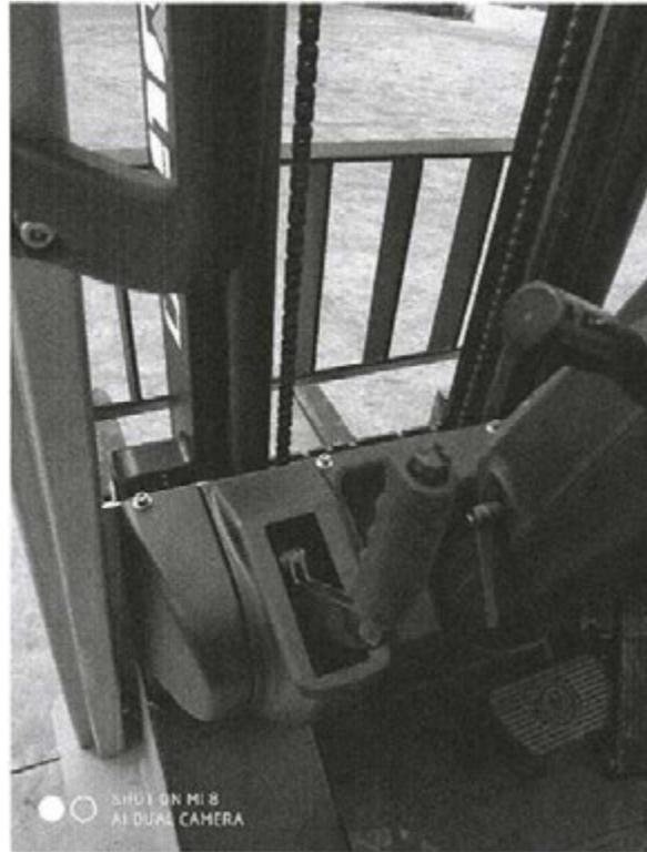
3. Aplique el freno de estacionamiento y suelte lentamente el freno de servicio.
