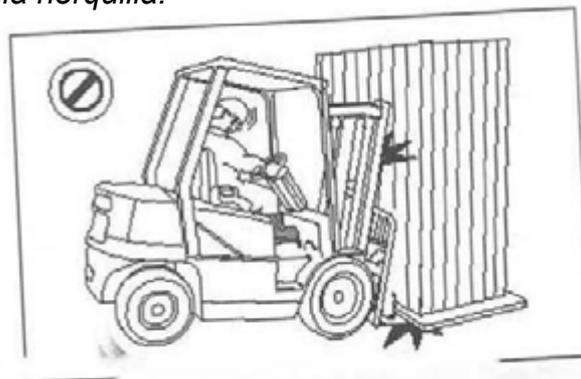
*No sobrecargue. No exceda la placa de curva de carga de la carretilla elevadora. No coloque contrapesos adicionales en la carretilla elevadora.*
