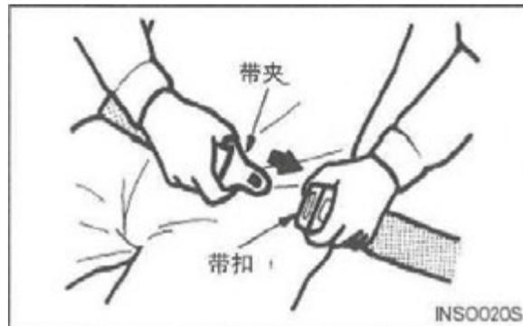
1. Sujete la hebilla (conexión) del cinturón de seguridad y, a continuación, tire del cinturón de seguridad para sacarlo de la carcasa. A continuación, introduzca el clip en la hebilla hasta oír un chasquido. Tire del cinturón de seguridad para asegurarse de que esté abrochado.
