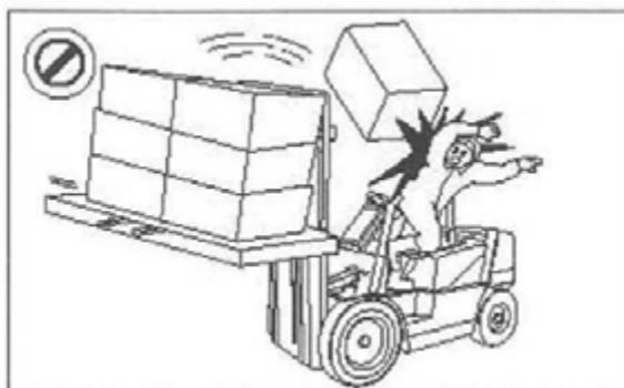
*No utilice una carretilla elevadora sin un bastidor y un tejadillo de protección instalados. Inclíne el mástil hacia atrás de modo que la carga descansa sobre el tope trasero.*
