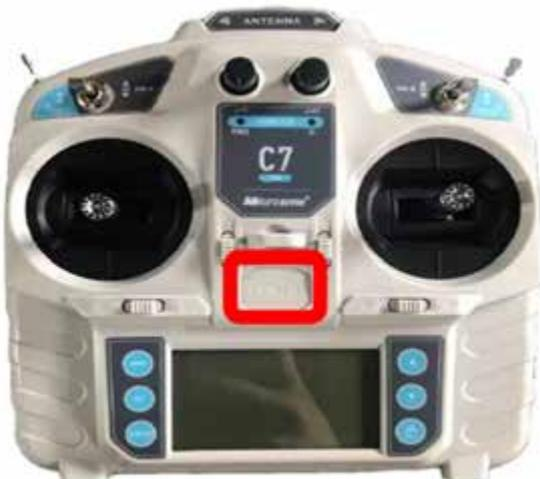
Paso 6. Presione hacia arriba el pulsador de arranque del control remoto.
