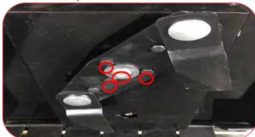
Paso 2: Retire la tuerca de fijación de la hoja, reemplace la hoja por una nueva y vuelva a fijarla.
