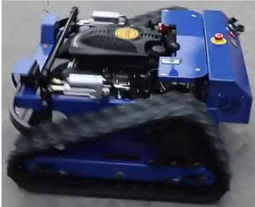
Adicionalmente, para el manejo de la desbrozadora de manera teledirigida o remota, se acompaña de un mando controlador de velocidad de giro de la cuchilla, velocidad de avance, sentido adelante atrás y direccionalidad. Este mando, funciona con baterías reemplazables.
