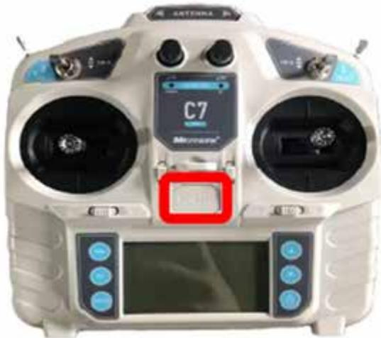
Paso 4. Opere el joystick del control remoto hacia la izquierda y hacia la derecha para bajar la desbrozadora por la rampa del vehículo
