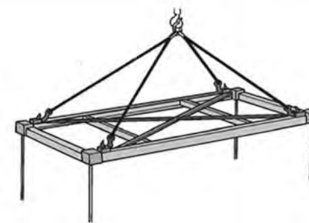
Ejemplo de elevación de contenedores mediante una viga de elevación equipada con ganchos, grilletes o un candado de elevación manual
