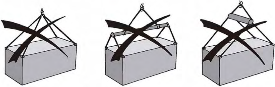
Ejemplo de un método de elevación que no debe utilizarse
