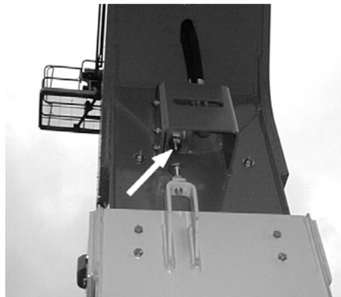
**Figura 2-8. Interruttore di fine corsa orizzontale del braccio a torre**
