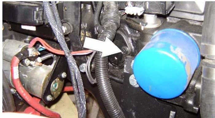
Punti di lubrificazione - tappo di rifornimento/filtro filettato
