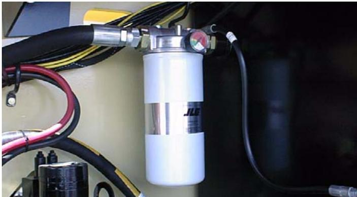
Intervallo - cambiare il filtro dopo le prime 50 ore e in seguito ogni 6 mesi o 300 ore o come indicato dalla spia di stato.
