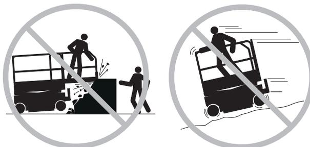
Ridurre la velocità di traslazione in base alle condizioni della superficie, alla situazione del traffico, alle pendenze, alla presenza di personale e ad altri fattori che potrebbero essere causa di collisioni.
