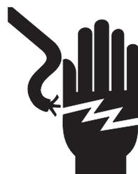
Collegare il caricabatterie soltanto a prese elettriche tripolari con collegamento di terra e protette da interruttore magnetotermico e differenziale.
