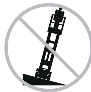
Non utilizzare l'allarme inclinazione come indicatore di livello. L'allarme di inclinazione suona sullo chassis soltanto quando la macchina si trova su una pendenza.
