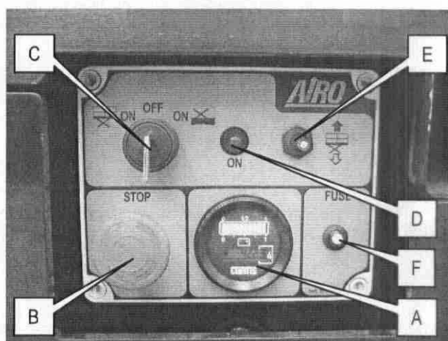
5-2: Quadro comandi a terra
