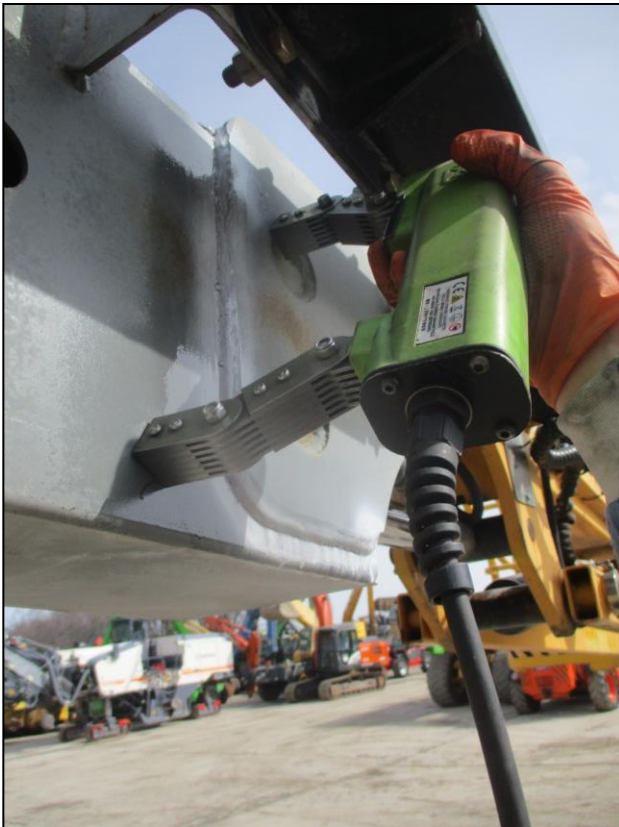
Figure 12 / 13 / 14 / 15 - Prove magnetoscopiche eseguite sulle saldature
