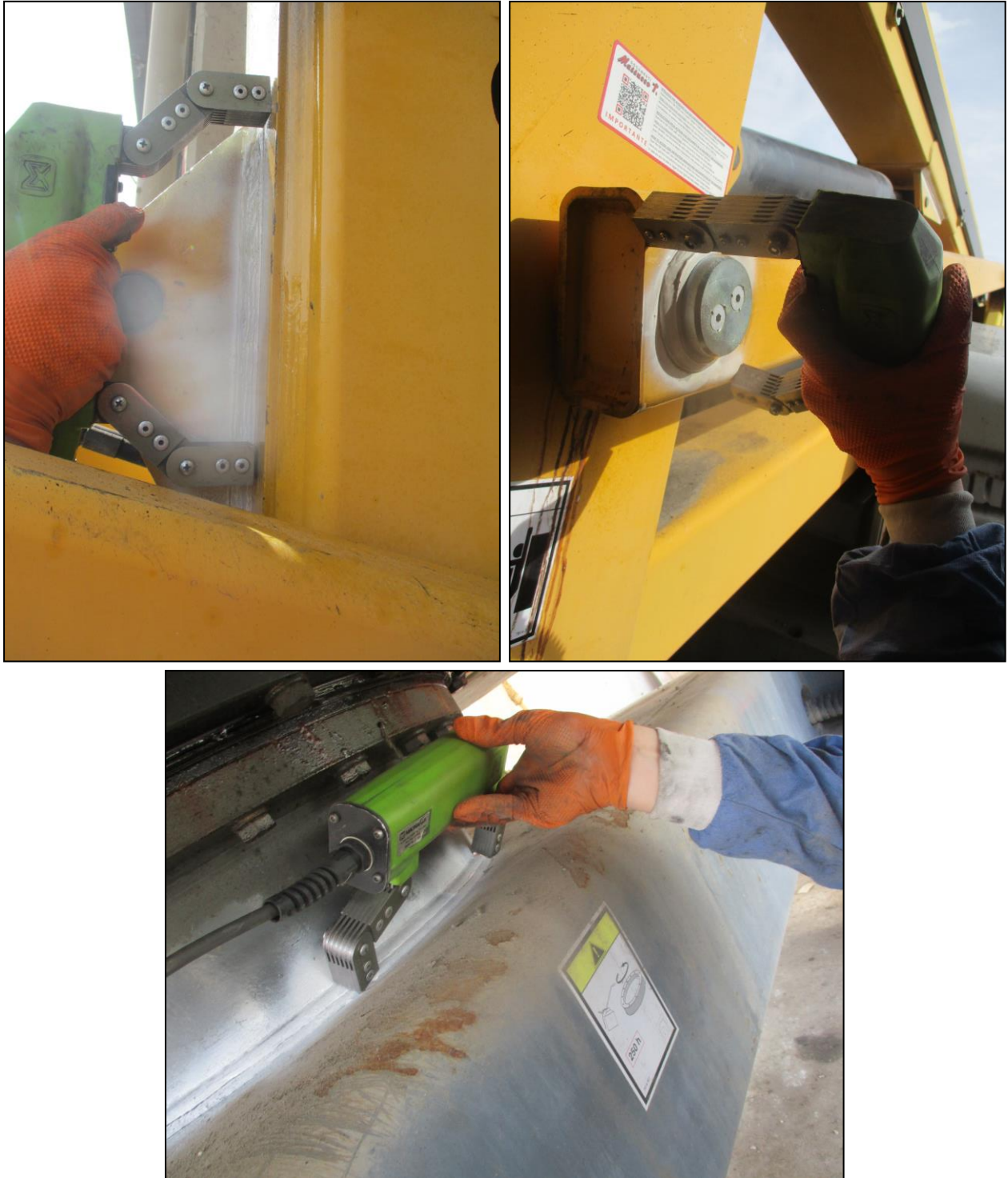
Figure 9 / 10 / 11 - Prove magnetoscopiche eseguite sulle saldature
