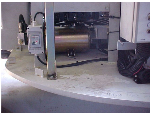
Foto 8 - Generatrice di bordo e relativo cofano di protezione
