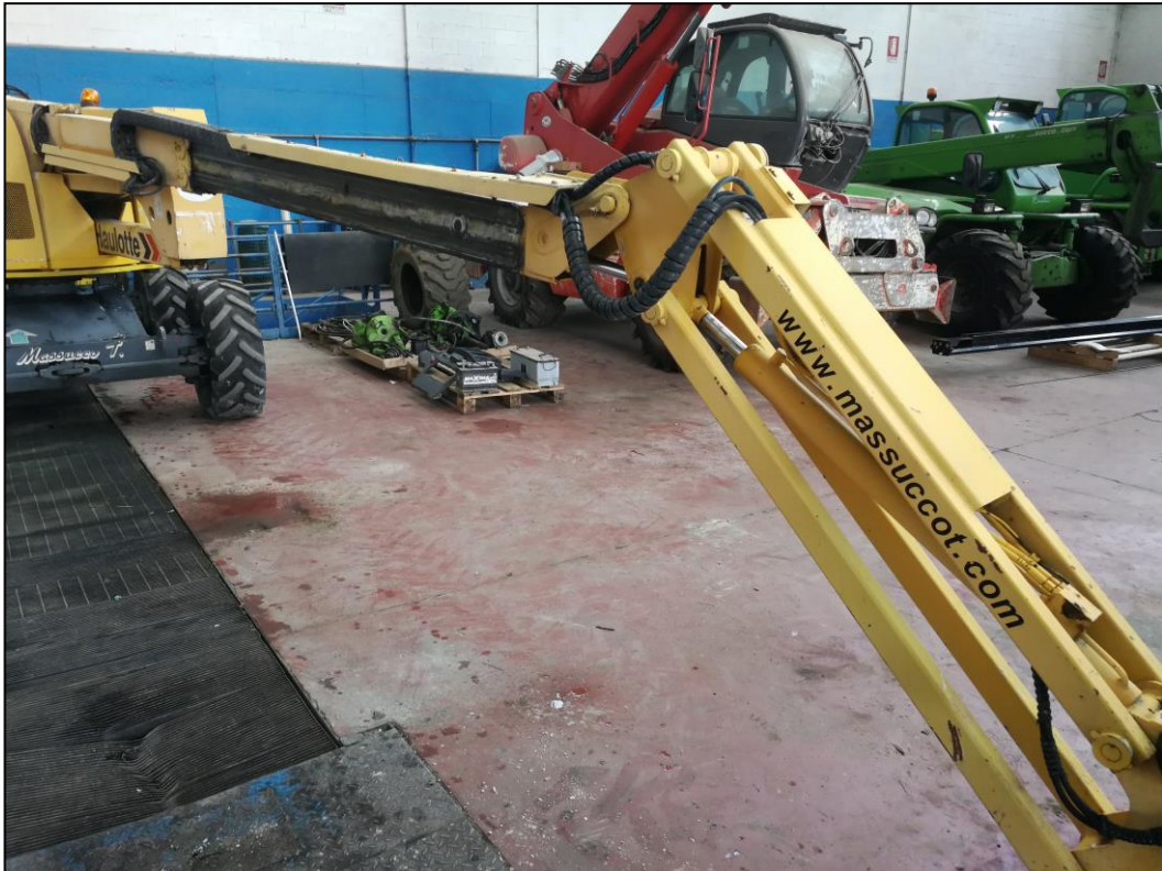
Figura 6 - Stato di conservazione della struttura estensibile
