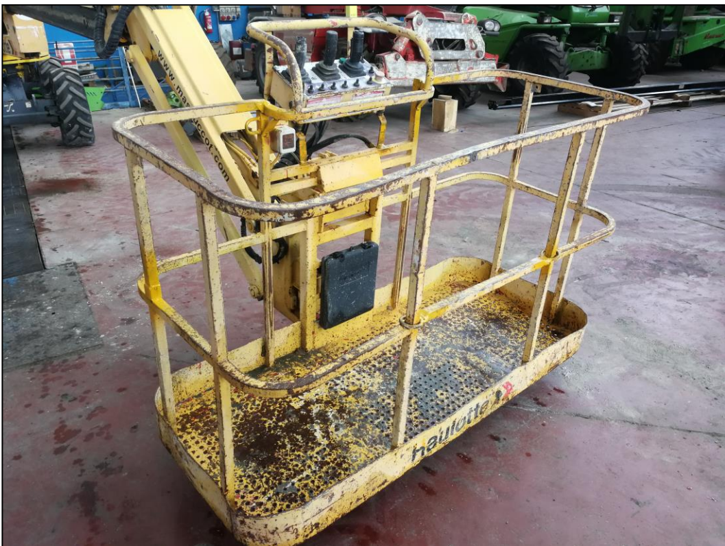
Figura 7 - Stato di conservazione del cestello
