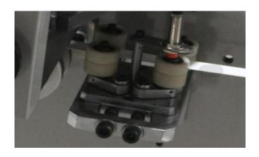
自动收封边条装置:伺服电机扭矩模式自动收卷,自动检测接头,自动裁断和收卷。
