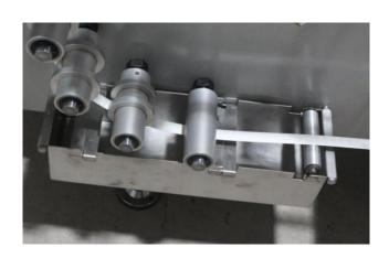
双平放封边条装置:多预留一个放封边条工位,提高工作效率。具有张力功能。
