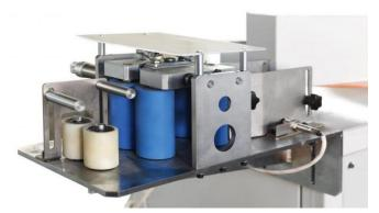
**封边条接头自动检测装置:**采用红外探头检测接头位置,自动控制涂胶头抬升和复位,实现不停机连续生产
