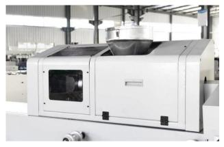
**刮刀装置:**采用进口钢材,涂胶均匀,涂胶口开合有刻度尺,整个刮刀具有上下和左右微调移动功能,涂胶控制精准。
